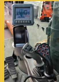
Le système est doté d'un programme d'assistance à l'opérateur qui indique la verticalité du profilé à l'aide d'un capteur d'angles transmettant les données en temps réel sur un écran à interface intuitive monté dans la cabine.
